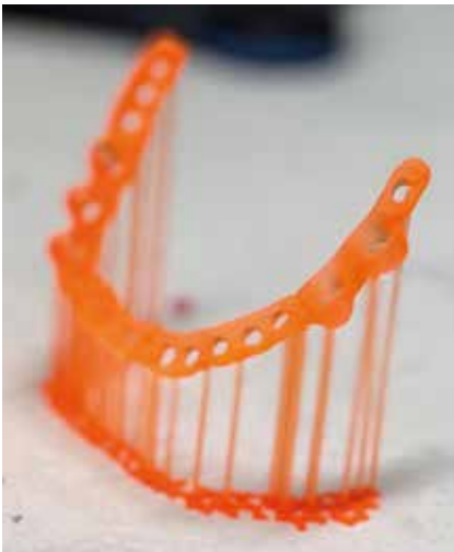
Abb. 7: Der gleiche Datensatz wird aus CAD/CAST-Material gedruckt, aber nicht zum Gießen, sondern als Aufstellbasis.
