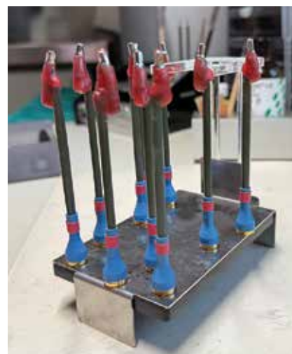
Abb. 3: Die Abutments sind mit Pattern Resin an den Elektroden befestigt und für die Galvanisierung vorbereitet.
