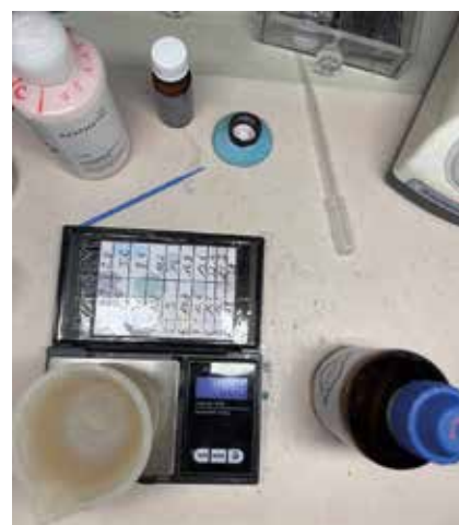
Abb. 15: Monomer und Kunststoffpulver werden genau abgemessen und gewogen, um einen möglichst reproduzierbaren Prozess zu gewährleisten.
