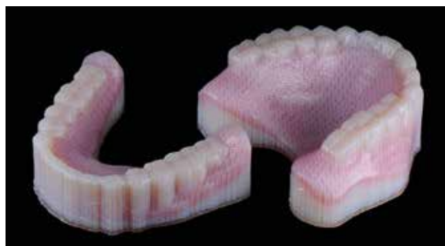
Abb. 14: Fertig gedruckte TrueDent-Prothesen aus der Bauplattform des J5 DentaJet-Druckers.
