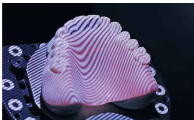
Abb. 1: Das Einscannen von vorhandenen Totalprothesen kann einerseits mittels Laborscanner und ...
