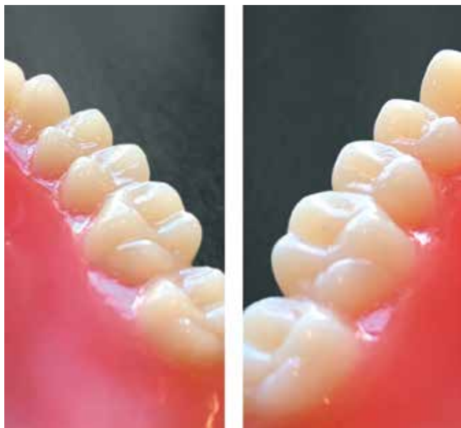
Abb. 1: Gefräste Prothesenzähne (links) und gedruckte Prothesenzähne (rechts): Zu erkennen ist der schichtweise Aufbau des Drucks. Die entstandenen Stufen müssen in diesem Fall manuell geglättet werden, um der vermehrten Plaquebildung entgegenzuwirken.
