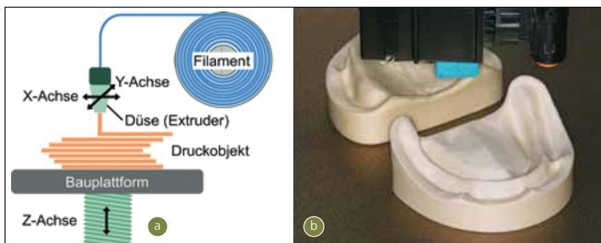
**Abb. 7:** (a) Schematischer Aufbau eines FDM-Druckers: Das Filament auf einer Spule wird dem Extruder zugeführt, dort geschmolzen und Schicht für Schicht in der X- und Y-Achse aufgetragen. Nach jeder Schicht wird die Z-Achse abgesenkt, und der Vorgang beginnt von Neuem. (b) Situationsmodelle eines unbezahnnten Ober- und Unterkiefers nach dem Druckvorgang vor dem Ablösen von der Bauplattform.
