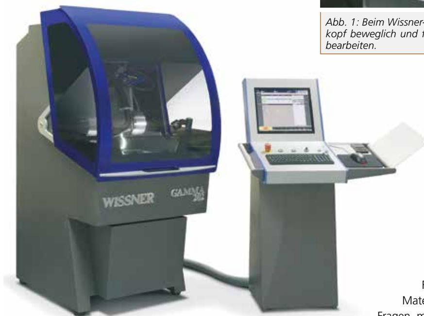
Abb. 2: Die Wissner-CNC-Fräsmaschine des Typs Gamma ist eine standfeste, doch kompakte Portalmaschine. Die komplette Portalständerkonstruktion wird als Monoblock in einem Stück gefertigt. Der Maschinenkörper ist steif und robust, um das Übertragen von Schwingungen auf das Werkstück zu vermeiden und die gesteigerte Präzision zu erreichen.
