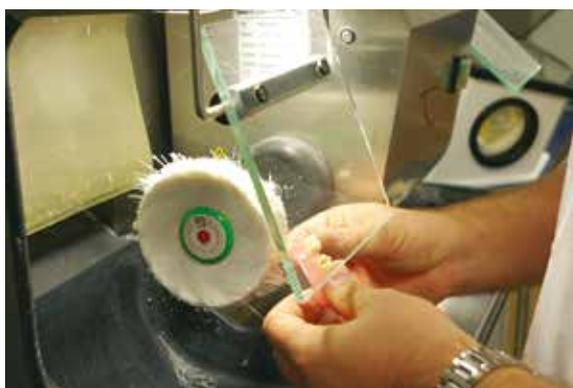
Abb. 2: Das POLIRET-Modell, hier mit Schwabbel an der linken Geräteseite. Die Absaugung nimmt den Schmutz direkt an der Spindel auf und führt ihn effektiv ab.
