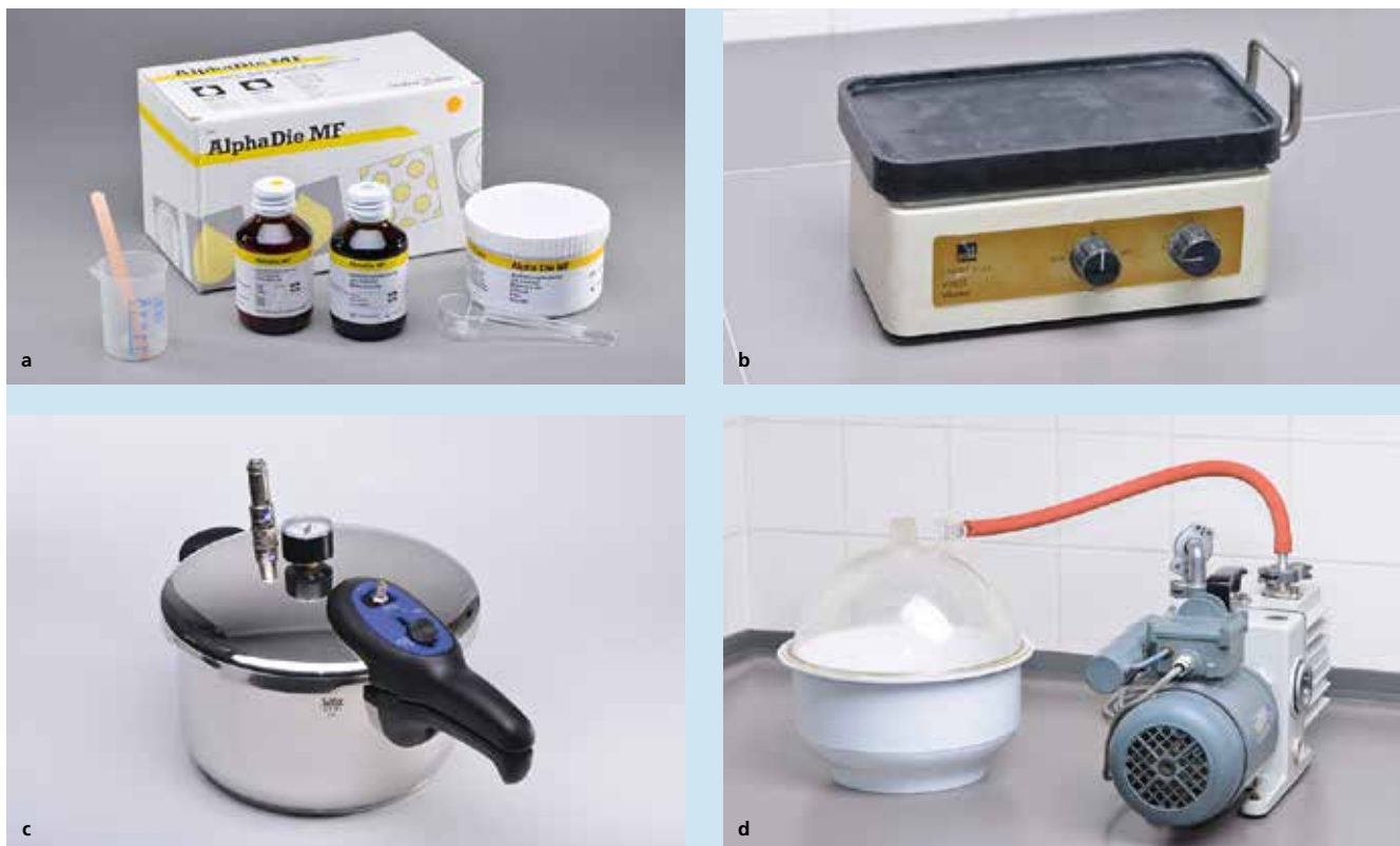
Abb. 4: Replikamaterialien sollten auf Polyurethan- oder Epoxidharzbasis sein (a), gut und homogen gemischt werden und blasenfrei in die saubere und trockene Abformung einfließen. Zahn technische Hilfsmittel wie Rüttler (b), Drucktopf (c) oder auch Vakuumexsikkatoren (d) sind unabdingbare Hilfsmittel für ein blasenfreies Ergebnis.
