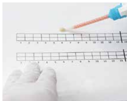
Abb. 8: Vor Gebrauch der Mischkanüle einen kleinen Überschuss absetzen, um von Beginn an eine optimale Durchmischung beider Komponenten zu gewährleisten.
